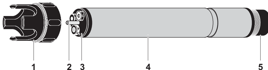
fig. 1-2 Architecture de la sonde NitraLyt ®Plus 700 IQ
